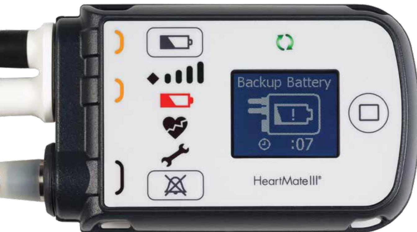
**WARNHINWEIS:** Der 11-Volt-Lithium-Ionen-Reserveakku ist nur zur vorübergehenden Verwendung bei einem Ausfall der Stromversorgung vorgesehen. Bei unsachgemäßer Verwendung des Reserveakkus kann es bei einem Ausfall der Stromversorgung zu einer verringerten Laufzeit kommen.
