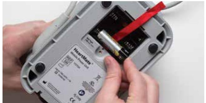
2. Öffnen Sie das Batteriefach und ziehen Sie am roten Band, um die Batterien herauszunehmen.
