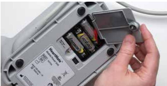
4. Schließen Sie das Fach und drehen Sie die Schraube fest.
