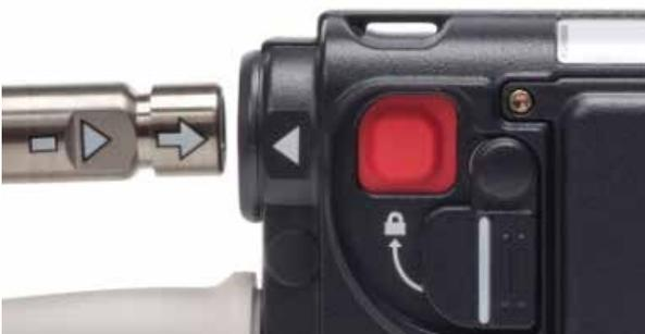
**Wichtig:** Wenn sich der Sicherheitsverschluss nicht vollständig über die rote Taste schieben lässt, ist die Driveline nicht ordnungsgemäß angeschlossen. Trennen Sie die Driveline und schließen Sie sie erneut an.
