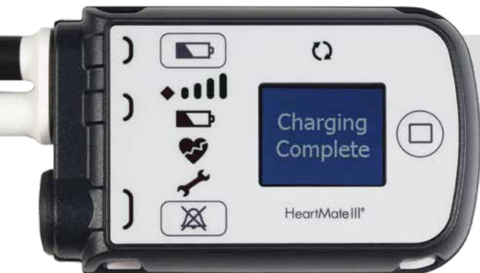
**WICHTIG:** Trennen Sie den Controller erst dann von der Stromversorgung, wenn die Meldung „Charging Complete“ (Laden abgeschlossen) angezeigt wird. Das Laden des Reserveakkus für den Systemcontroller kann bis zu drei Stunden dauern.
