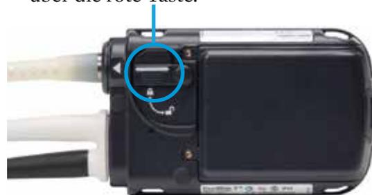
**B.** Drücken Sie die rote Taste und schieben Sie die Driveline vor, bis sie hörbar einrastet.
