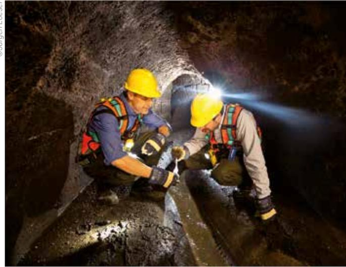
Abwasser-Monitoring: Probenentnahme im Untergrund (Symbolfoto)
