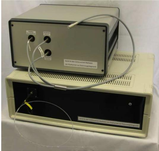
**Faseroptische Fluoreszenzspektrometer.** Abgebildet sind zwei Geräte zur Evaluierung in klinischen Studien. Das untere Gerät wurde in der ersten Phase der klinischen Studie im Jahr 2013 eingesetzt. Das obere Gerät ist ein weiterentwickeltes Gerät, dessen Evaluierung Ende 2013 begonnen wurde.
